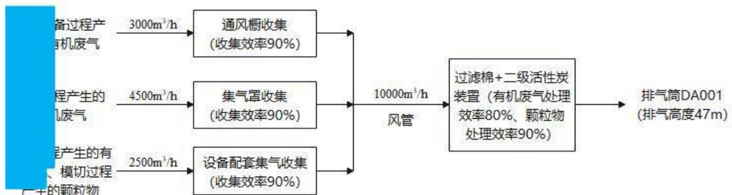
图 4-1 有组织废气处理工艺流程图
