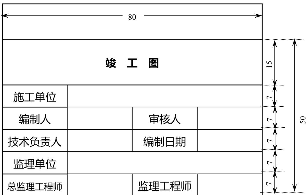
六、利用施工图改绘竣工图，必须标明变更修改依据；凡施工图结构、工艺、平面布置等有重大改变，或变更部分超过图面 1/3 的，应当重新绘制竣工图，注册章、出图章与竣工章应符合国家现行有关制图标准的规定。
